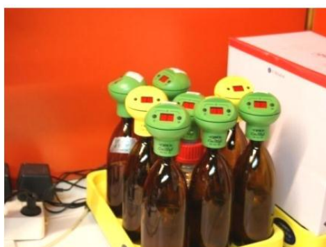
Figure 2: La figure montre l'Installation de mesure de la DBO 5 (Oxitop).
