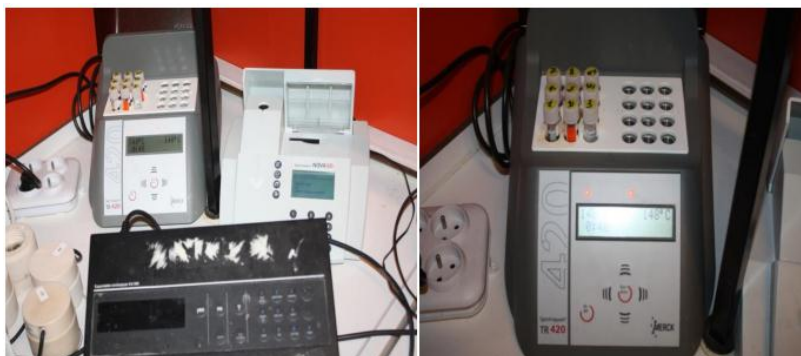
Figure 1: La figure montre l'Appareillage pour mesurer de la DCO.
