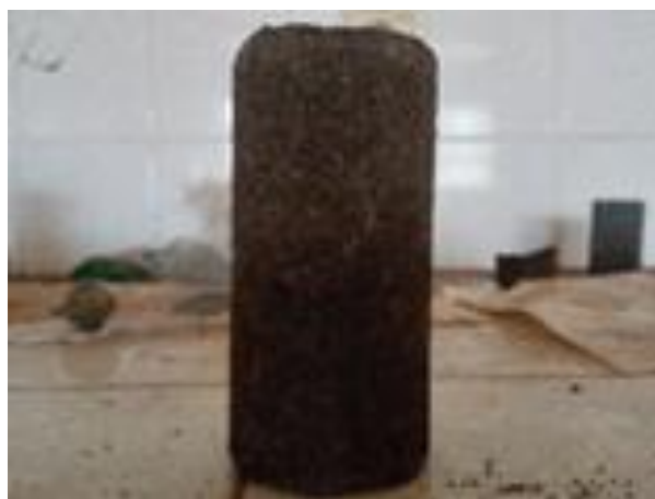
Figure 3 : Eprouvette cylindrique pour essai de compression.
