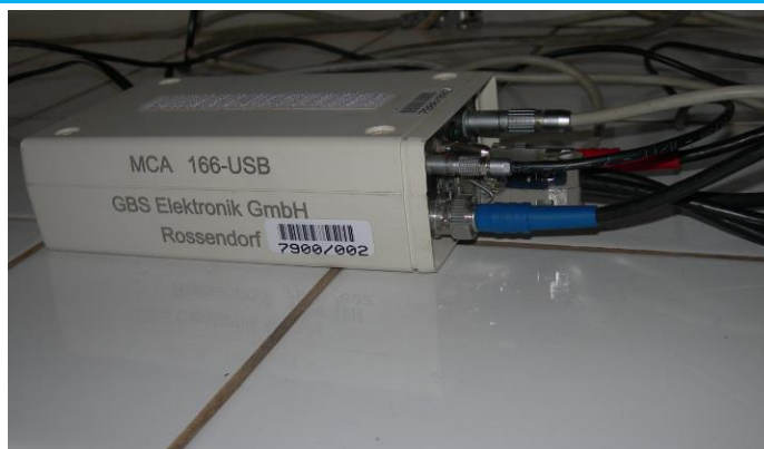
Figure 3 : analyseur multicanaux MCA-166 pour classer les impulsions en fonction de leur amplitude.
