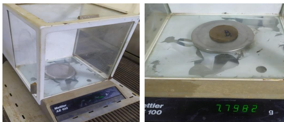
Figure7 : Balance de précision de laboratoire de matériaux. METTLER AE 100.
