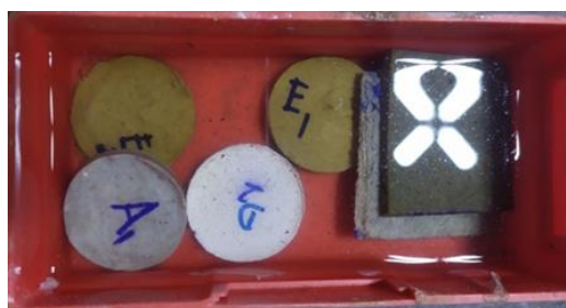
Figure 16 : Eprouvettes trempées dans l'eau.
