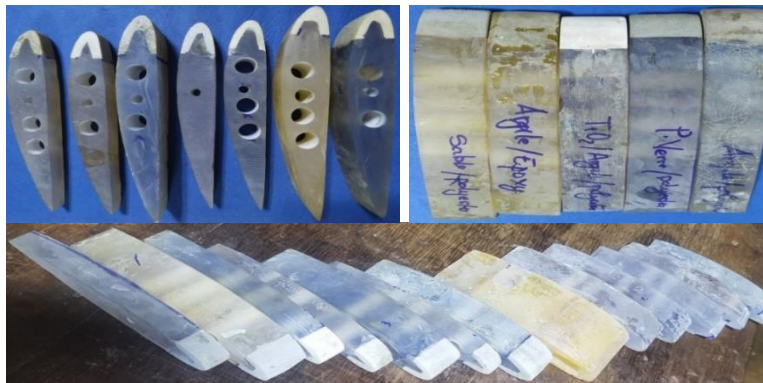
Figure 22 : Epreuve avec bord d'attaque renforcé
