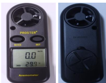
Figure9 : Anémomètre portable, PROSTER.
