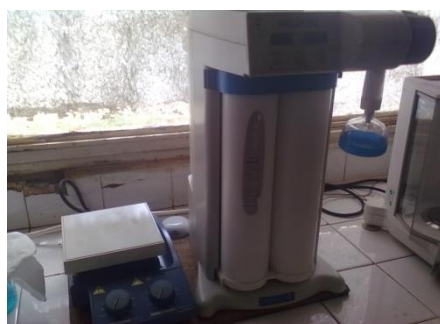
Figure 3 : Résistance électrique et le Dé-ioniseur d'eau de marque Simplicité
