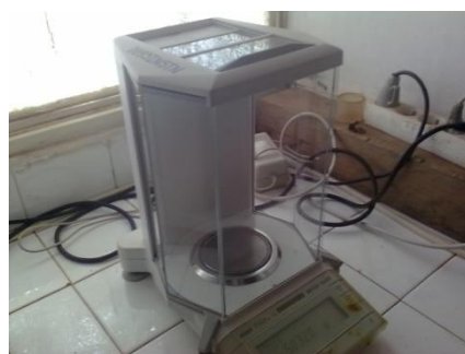
Figure 4 : Balance électronique de marque Mettler Toledo AG285, précision 0,01mg.
